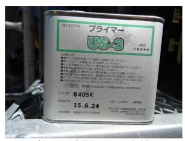
コーキングをしっかり密着させるため、充填部に接着剤的下塗材「プライマー」をハケ塗りします。 ここで手を抜くとコーキングが剥がれやすく、 剥がれたらまた撤去してやり直しになるわけですから、 非常に重要な工程です。
